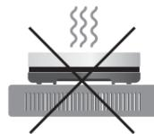
**NO APILAR** este equipo con ningún otro equipo electrónico o fuente de calor.
